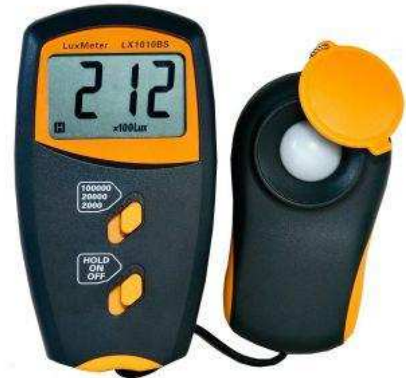
Luxmeter zum Messen der Beleuchtungsstärke
