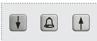
Im Konfigurationsmodus kann das Displayruf-Modul auf einen bestimmten Rufzielbereich eingestellt und die Anzeigesprache definiert werden. Über die Pfeiltasten wird zwischen den Menüeinträgen gewechselt. Mit Betätigen der Glocke-Taste gelangen Sie in den ausgewählten Einstellungsbereich bzw. verlassen die Konfiguration.
