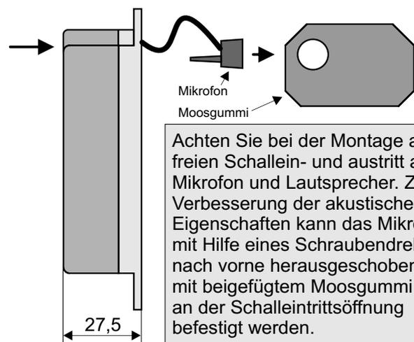
Achten Sie bei der Montage auf freien Schallein- und austritt an Mikrofon und Lautsprecher. Zur Verbesserung der akustischen Eigenschaften kann das Mikrofon mit Hilfe eines Schraubendrehers nach vorne herausgeschoben, und mit beigefügtem Moosgummi direkt an der Schalleintrittsöffnung befestigt werden.
