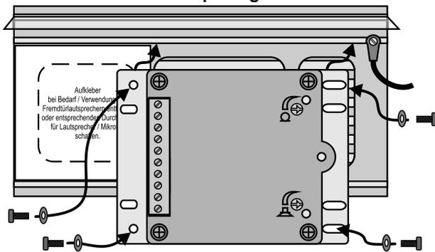
Montage am ELCOM Sprechgitter mit Hilfe der beigefügten Schrauben (M3x8).
