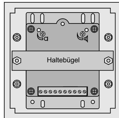
Montage mittels Haltebügel
