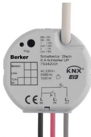
Der Schaltaktor empfängt Telegramme von Sensoren über den Instabus und schaltet mit seinen zwei funktional voneinander unabhängigen Relaiskontakten elektrische Verbraucher.
