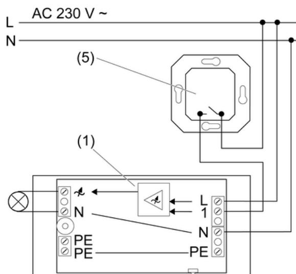
Bild 5: Anschlussplan Schnurdimmer mit Installationstaster
