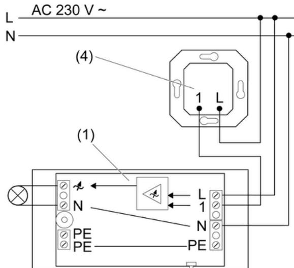
Bild 4: Anschlussplan Schnurdimmer mit Nebenstelle 2-Draht
