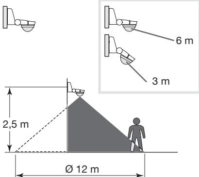
La hauteur d'installation optimale est de 2,5 m.
