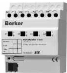
Der Schaltaktor empfängt Telegramme über den EIB und schaltet mit seinen vier potentialfreien, voneinander unabhängigen Relaiskontakten Gruppen von elektrischen Verbrauchern. Es können verschiedene Außenleiter angeschlossen werden. Die Applikation ermöglicht Schalten mit Rückmeldung, Verknüpfung und Zeitfunktion. Mit den Schiebeschaltern können durch Handbetätigung die 4 Relais parallel zum instabus EIB, bzw. ohne instabus EIB ein- und ausgeschaltet werden.
