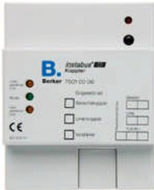
Der Bereichs- / Linienkoppler verbindet datentechnisch zwei *instabus* EIB Linien miteinander und gewährleistet eine galvanische Trennung zwischen diesen Linien.
