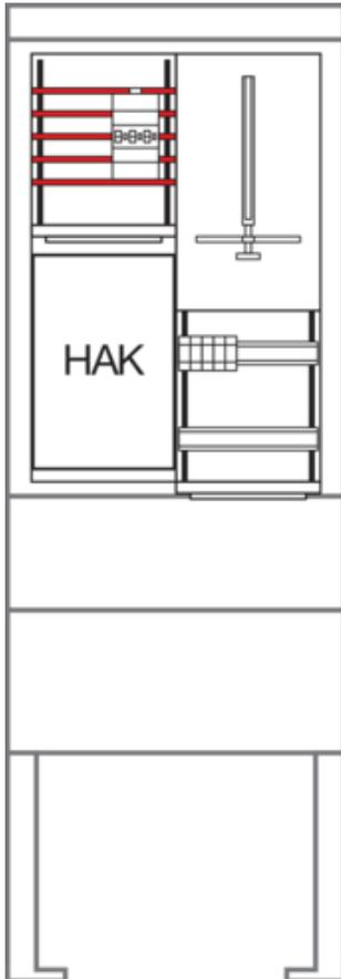
**Zähleranschlussssäule 175, universZ, 1 Zählerplatz, 3-Punkt, 5-polig, Basis**
