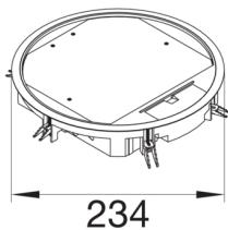
**Versorgungseinheit R06 rund 215mm für 5mm Bodenbelag aus Polyamid eisengrau**
