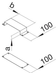
**Dehnungsmuffe zur Verbindung zweier Kanäle über Dehnungsfugen für Kanal 190x38mm**
