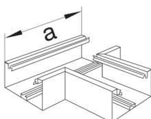
**T-Stück aus Grundprofil zu Brüstungskanal BR 85x130mm aus PVC in lichtgrau**
