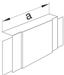
**T-Stück aus Kunststoff halogenfrei zu Leitungsführungskanal LF 18x45mm lichtgrau**
