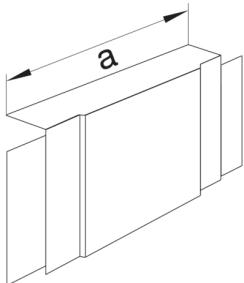
**T-Stück schnittkasierend aus Kunststoff halogenfrei zu LF 25x25mm steingrau**
