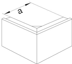
**Außeneck aus Grundprofil aus PVC zu Leitungsführungskanal FB 100x230mm reinweiß**
