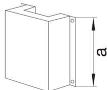
**Schiebemuffe Brandschutzkanal FWK 90 Funktionserhalt E60/E30 50x60mm verzinkt**
