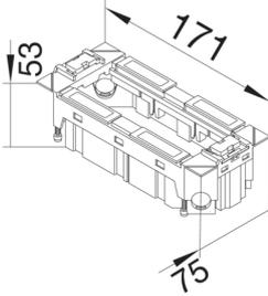
**Geräteträger f 3 Rastec 45 Geräte o 2 Tragstepper aus PA zu VQ06/VR06/VR10(r, l)**
