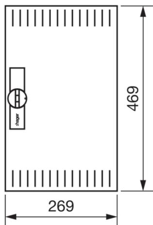
**Tür, univers, rechts, geschlitz, RAL 9010, für Schrank IP3X, 500x300mm**
