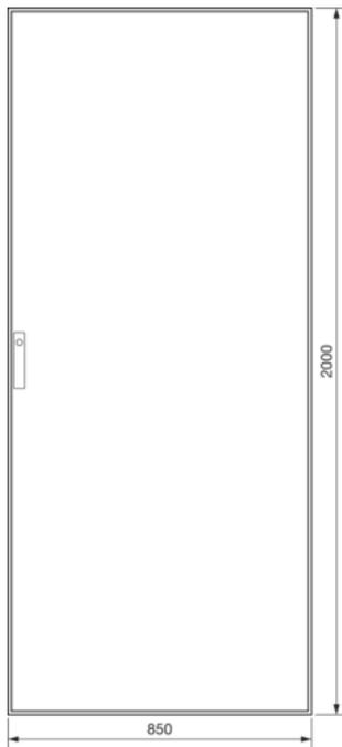
**Anreihstandsverteiler IP41 850x2000x600 120° RAL7035 Rückwand verzinkt**
