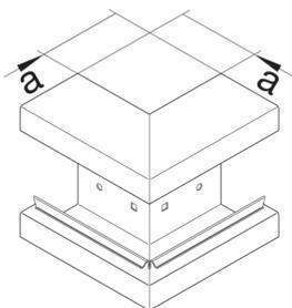
**Außeneck aus Grundprofil zu BRS 68x170mm Oberteil 120mm aus Stahlblech lichtgrau**
