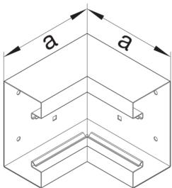
**Inneneck aus Grundprofil zu BRS 100x170mm Oberteil 80mm aus Stahlblech verzinkt**
