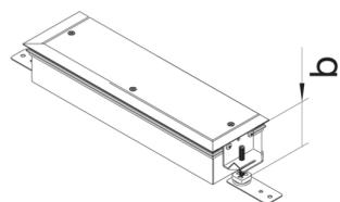
**Endstück höhenverstellbar mit Wanne aus Stahlblech zu BKW 250x(90-130)mm**
