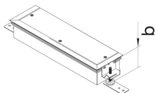
**Endstück höhenverstellbar mit Wanne aus Stahlblech zu BKW 200x(60-100)mm**
