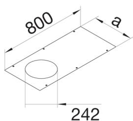
**Abdeckung gestanz R2 rund 242mm aus Stahlblech zu BKF/BKW 400x800mm**
