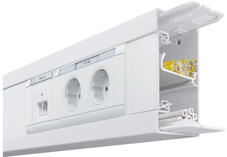
In öffentlichen Gebäuden wird häufig der Einsatz halogenfreier Leitungssysteme gefordert. Das hat einen triftigen Grund: Halogenfreie Materialien bieten im Brandfall besseren Sachwertschutz, da sie keine korrosiven Stoffe freisetzen, die zu beträchtlichen Brandfolgeschäden führen können. Der neue tehalit.BRH65 erfüllt die Anforderungen der DIN EN 50085 an Halogenfreiheit und ist zudem noch einfach zu planen und zu installieren.
