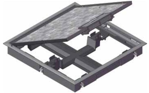
Für Böden ab 50 mm Stärke hat Hager den ultraflachen Klappdeckel KDQ08 (quadratisch) im Programm. In Kombination mit den Gerätebechern GBES2 oder GBM5050 können sie mit acht Installationsgeräten bestückt werden. Als Sonderlösung ist auch eine Versorgung mit Datenanschlüssen möglich.
