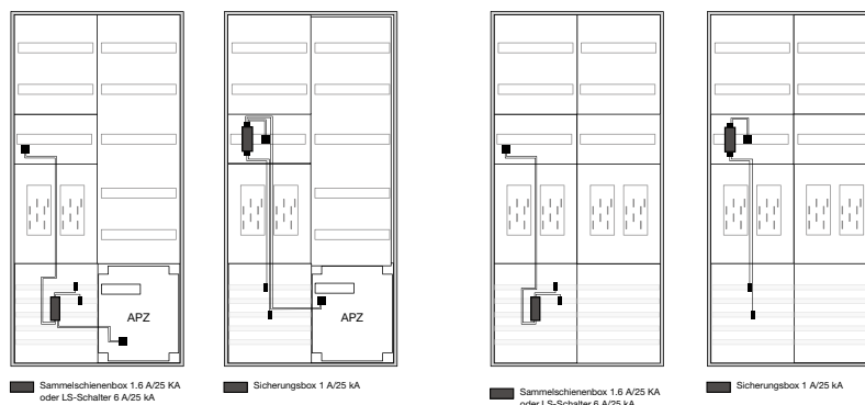
Abbildung 6: LS-Schalter (25 kA) auf Geräteträger, (Spannungsabgriff aus NAR, ungezählt) mit Einspeiseadapter
